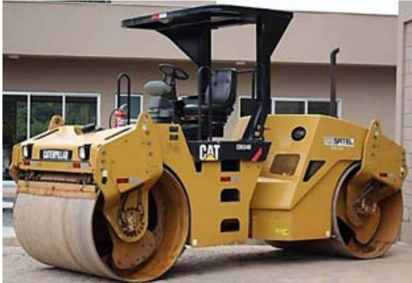
Figura 21 - Equipamento de compactação mecânica tipo rolo vibratório.
