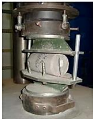
Figura 6 – Ensaio de tração por compressão diametral.
