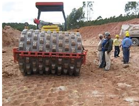
Figura 18 - Equipamento de compactação mecânico tipo rolo pé-de-carneiro.
