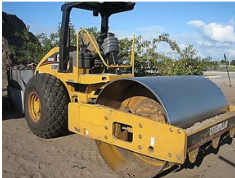
Figura 19 - Equipamento de compactação mecânico tipo rolo liso.
