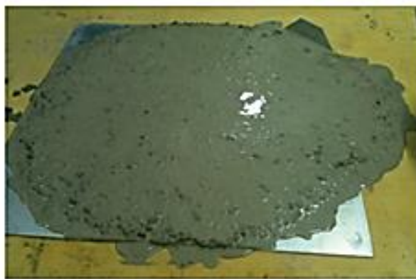
Figura 3 – Ensaio de espalhamento de um concreto autoadensável (altos níveis de exsudação e segregação)
