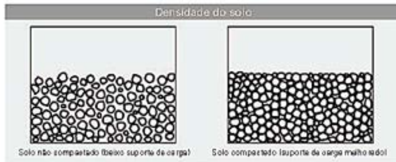
Figura 11 – Aspecto dos grãos do solo antes e após compactação.
