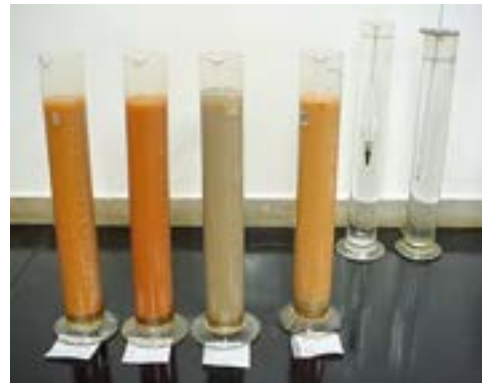
Figura 2 - Separação do solo pelo método das peneiras e por sedimentação.
