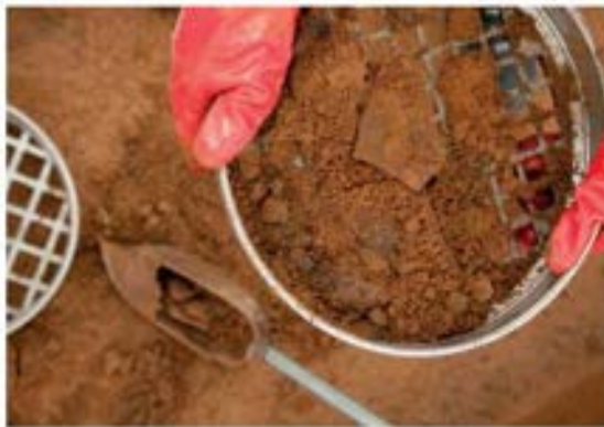
Figura 2 - Separação do solo pelo método das peneiras e por sedimentação.
