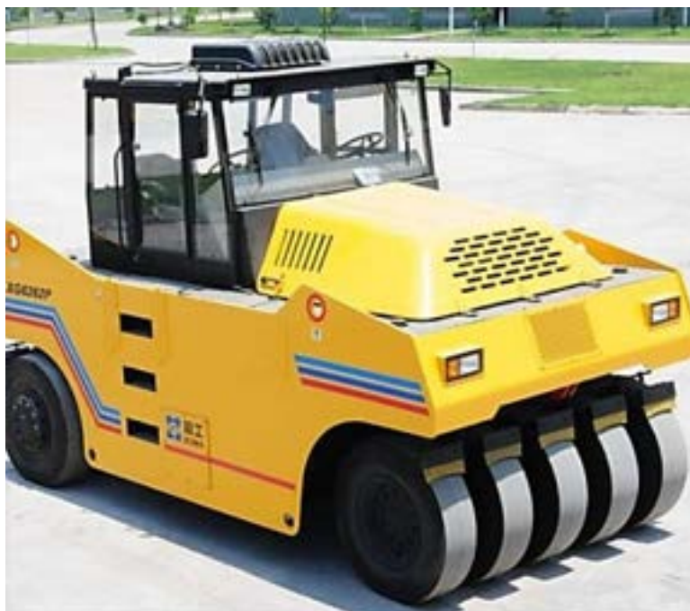
Figura 20 - Equipamento de compactação mecânico tipo rolo pneumático.
