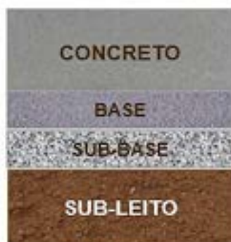
Figura 1 – Camadas estruturais do pavimento de concreto.
