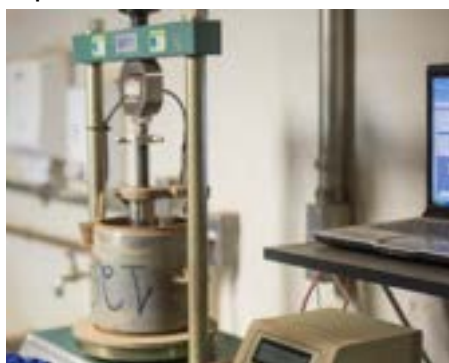
Figura13 – Ensaio de CBR.
