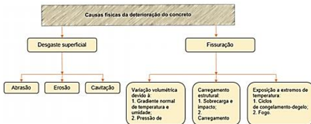
Figura 9 – Causas físicas da deterioração do concreto.
